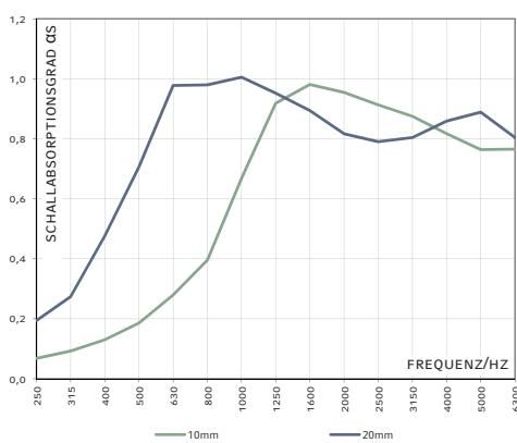
► Unser Akustikschaumstoff **soni 491 SK** wird erfolgreich zur Schallbekämpfung und Temperaturisolierung in Motor- und Fahrzeuginnenräumen eingesetzt. Es erfüllt die für den Fahrzeugbau erforderlichen Brandnormen gemäß FMVSS 302 und DIN 75200. Auch zur Dämmung Ihres Rolladenkastens können wir Ihnen den PUR-Schaumstoff uneingeschränkt empfehlen.
