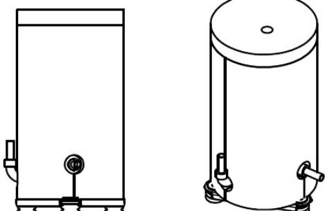
Envelopper le compresseur avec la housse - face noire vers l'extérieur. Poser le capot puis assembler avec la bande adhésive soni VLC-01.
