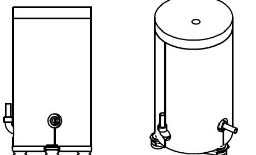
Verdichter mit dem Mantel - schwarze Seite nach außen - umschließen. Deckel aufsetzen und anschließend mit Klebeband soni VLC-01 die Stoßstellen versiegeln.
